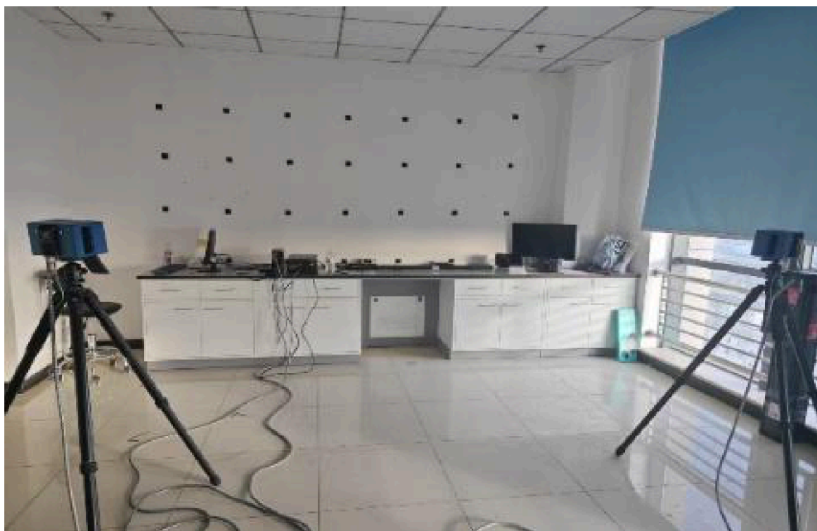
光学测量系统现场布置示例
